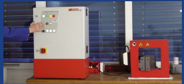
La commande est faite à distance de sécurité de la bobine pour éviter une exposition aux champs magnétiques non autorisés.
