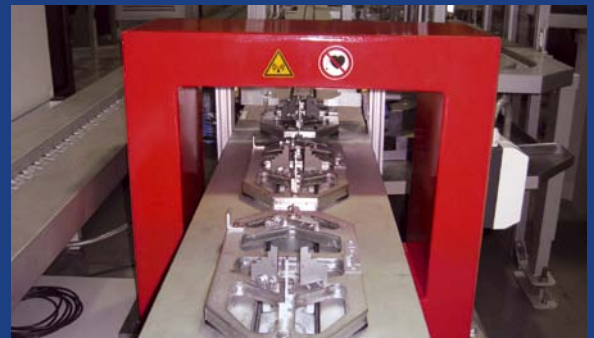
Enclenchement de l'impulsion par barrière lumineuse sur une ligne de production.
