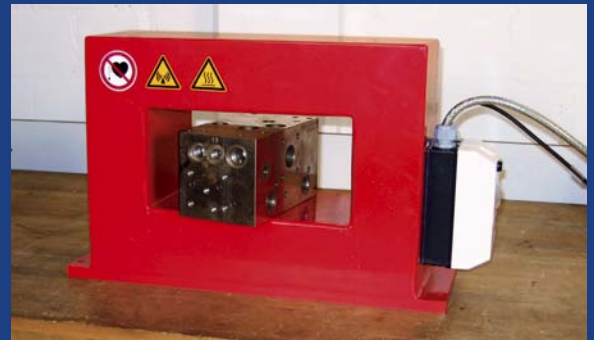
Démagnétisation fiable, même avec un fort taux de remplissage.
